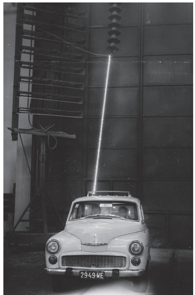
Eksperyment ochrony przed wyładowaniem z udziałem M. Jaczewskiego w Hali Wysokich Napięć (fot. ze zbiorów J. Dąbrowskiego)
