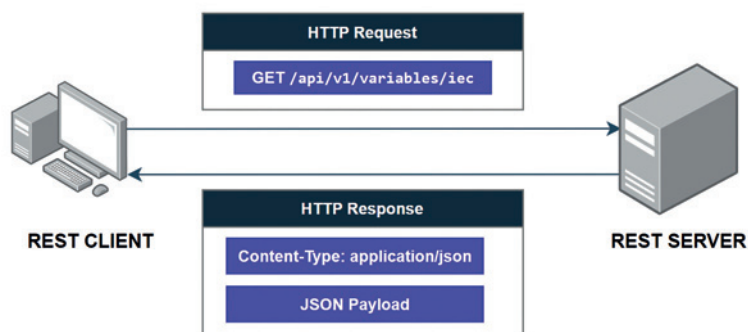
Rys. 2. Komunikacja za pomocą interfejsu REST API
