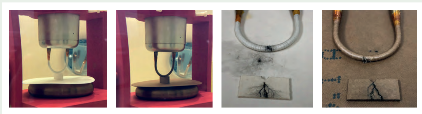
Rys. 9. Próbki w trakcie badań w uchwycie testowym olej badany (po lewej), izolacja celulozowa (po prawej), u góry: elektroda wysokonapięciowa, u dołu: elektroda uziemiona [28]
