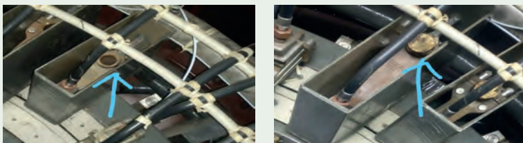
Rys. 22. Wlot wodoru do pręta stojana, otwarty i z zaślepką transportową
