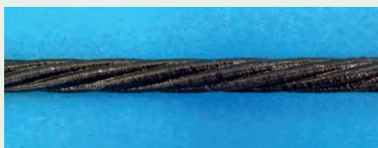
Rys. 17. Rdzeń przewodu oraz przekrój przewodu pobranego z miejsca o największym zwisie [33]
