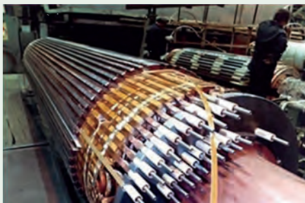
Rys. 20. Widok wirnika generatora typu T3B z chłodzeniem wodnym
