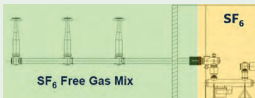
Rys. 17. Podział węzła z izolacją gazową na część zawierającą SF 6 i wolną od SF 6
