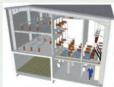
Rys. 3. Wnętrzowa, kompaktowa rozdzielnica z izolacją powietrzną
