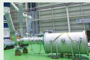
Rys. 10. Stanowisko badawcze dla przyspieszonego procesu starzenia izolatorów przepustowych rozdzielnicy GIS
