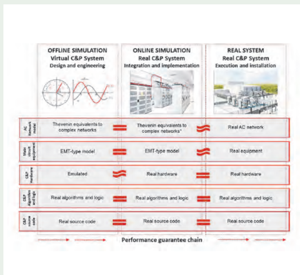
Rys. 17. Porównanie szczegółowości modeli dla symulacji offline, symulacji online i rzeczywistego systemu [46]
