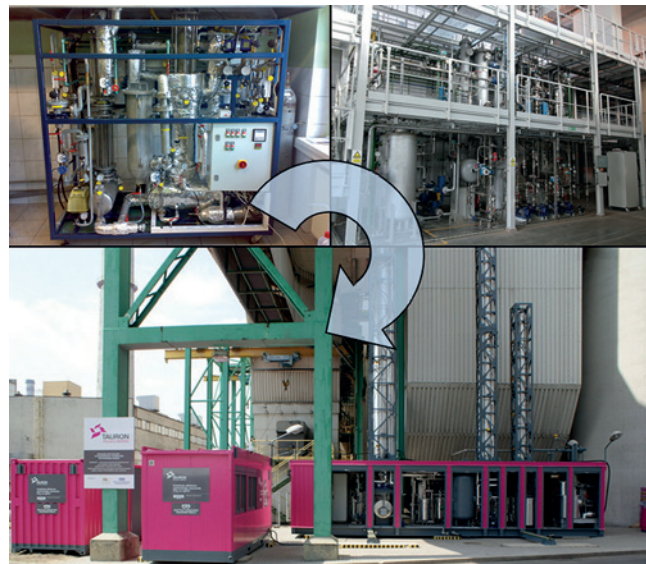
Rys. 1. Skalowanie procesu usuwania CO 2 na przykładzie technologii opracowanej w Instytucie
